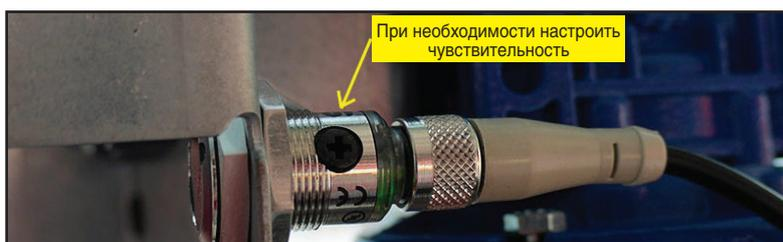
**Регулировка фотоэлементов антизаклинивания**
